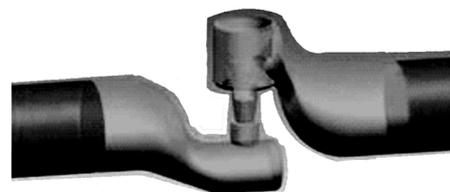
图1 调节阀 CFD 模型
